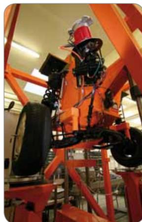
Banc de test de la dynamique verticale d'un train avant de véhicule
