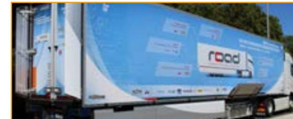
ROAD – Semi-remorque frigorifique fonctionnant à l'hydrogène. Tests en conditions réelles. Système pile à combustible fourni par H2SYS (90).
