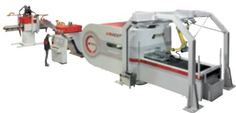
LINACUT : machine de découpe laser à partir de bobines
