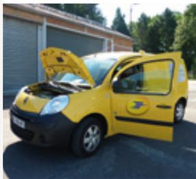
MOBILHyTEst est un projet de validation opérationnel pour la distribution du courrier effectuée avec des véhicules Kangoo électriques équipés de pile à combustible et d'un réservoir d'hydrogène. Les tests sont réalisés par le
